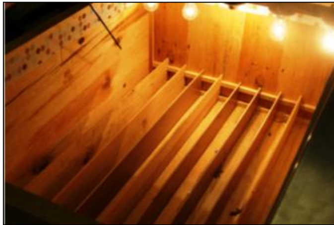
Figura 4. Gradiente térmico para obtener el intervalo de temperaturas preferidas ( T_p ) de las lagartijas. El gradiente consiste en un cajón de madera con carriles donde las lagartijas pueden moverse entre zonas con distintas temperaturas.
