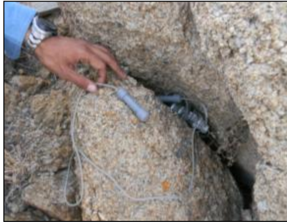
Figura 3. Colocación de un modelo nulo de PVC dentro de una grieta rocosa. En la imagen se observan dos modelos nulos (color gris) conectados a un datalogger HOBO® (Onset, Model U23-003).
